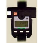
Com hem dit al començament, l'emissió de monòxid de carboni es va mesurant contínuament durant tot el dia. Es disposa d'un sistema d'alarma que es dispara en cas de que l'emissió superi un determinat valor (60.000 µg/ m<sup>3</sup>). L'alarma provoca que s'alentixi el procés de producció fins que les emissions tornen a ser acceptables. Cal dir que aquest procés és molt ràpid i mai supera els deu minuts.
